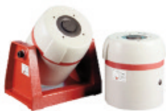
Figura 3 : shaker per applicazioni di laboratorio (analisi delle vibrazioni)
